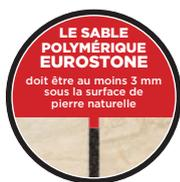
Largeur maximale des joints 3.5 cm
