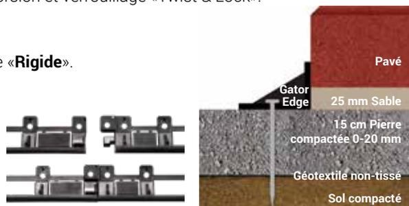
**Utilisation:** La bordure **GATOR EDGE** constitue un excellent choix pour retenir pavés, dalles, ou pierres pour les allées, les accès de voiture et les trottoirs. Les bordures **GATOR EDGE** sont conçus pour la mise en place rectiligne ou sinueuse. Ils sont particulièrement faciles d'utilisation et rapides d'installation.
